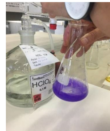
Figura 1. Valoració de l'amoxicil·lina amb l'àcid perclòric
